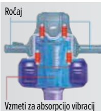
Vzmeti za absorpcijo vibracij
